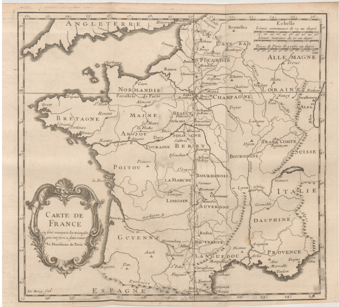
FIG. 148. CARTE DE FRANCE OU SONT MARQUEZ LES TRIANGLES QUI ONT SERVI A DETERMINER LA MERIDIENE DE PARIS (1720). Illustration from Cassini II's De la grandeur et de la figure de la Terre, Suite des Mémoires de l'Académie Royale des Sciences, année 1718 (Paris: Imprimerie Royale, 1720).
