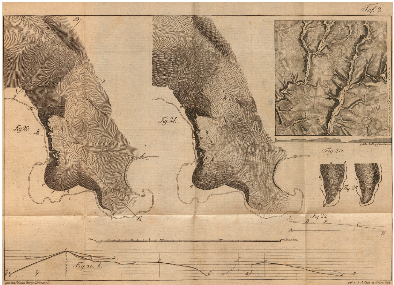
FIG. 356. CONSTRUCTION OF VARIABLY SPACED HACHURES VIA CROSS-SECTIONS AND EXAMPLE MAPS. From Johann Georg Lehmann, Darstellung einer neuen Theorie der Bezeichnung der schiefen Flächen im Grundriß oder der Situationszeichnung der Berge (Leipzig: Johann Benjamin
